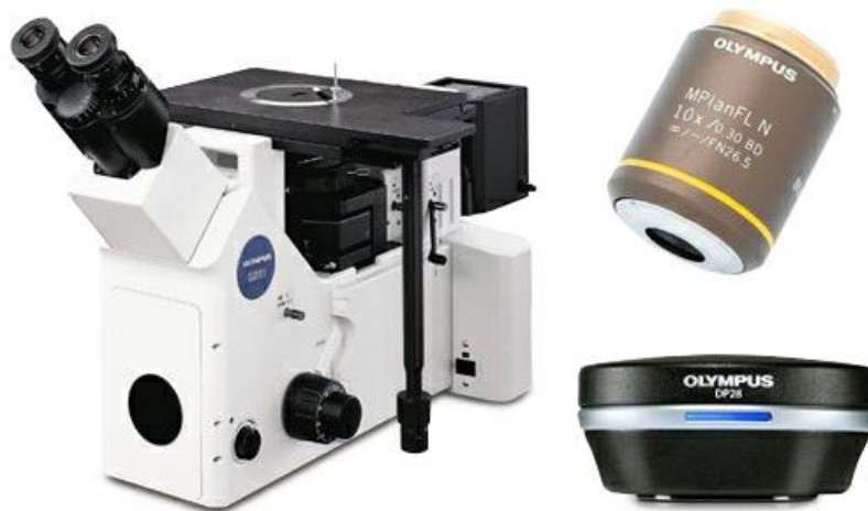
Tipica configurazione dell'apparecchiatura: microscopio metallografico rovesciato, obiettivo metallografico 10X e fotocamera per microscopio digitale a alta risoluzione
